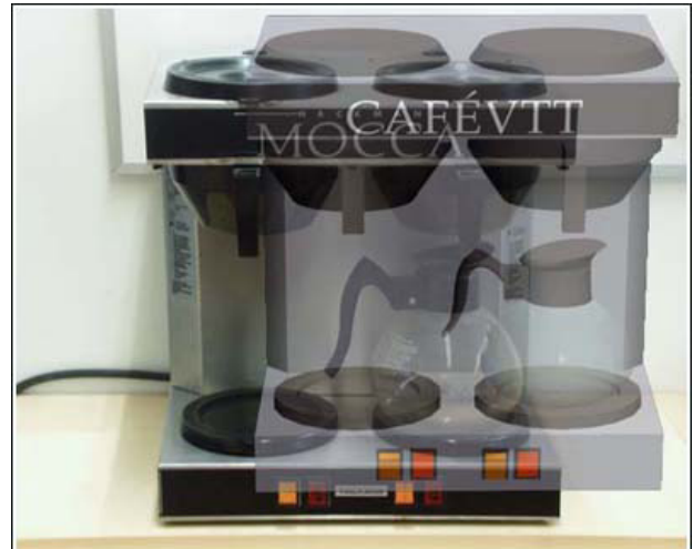
Kuva on ilmeisesti VTT:n ensimmäisestä Augmented Reality -sovelluksesta. Suomeksi termi tarkoittaa lisättyä todellisuutta eli tässä tapauksessa todellisuuden ja virtuaaliobjektien tai -tilojen liittämistä toisiinsa.
